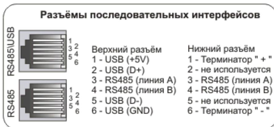
Рисунок 10.2 – Назначение контактов разъемов
