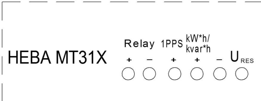
Схема подключения испытательных выходов счетчиков HEBA MT315
